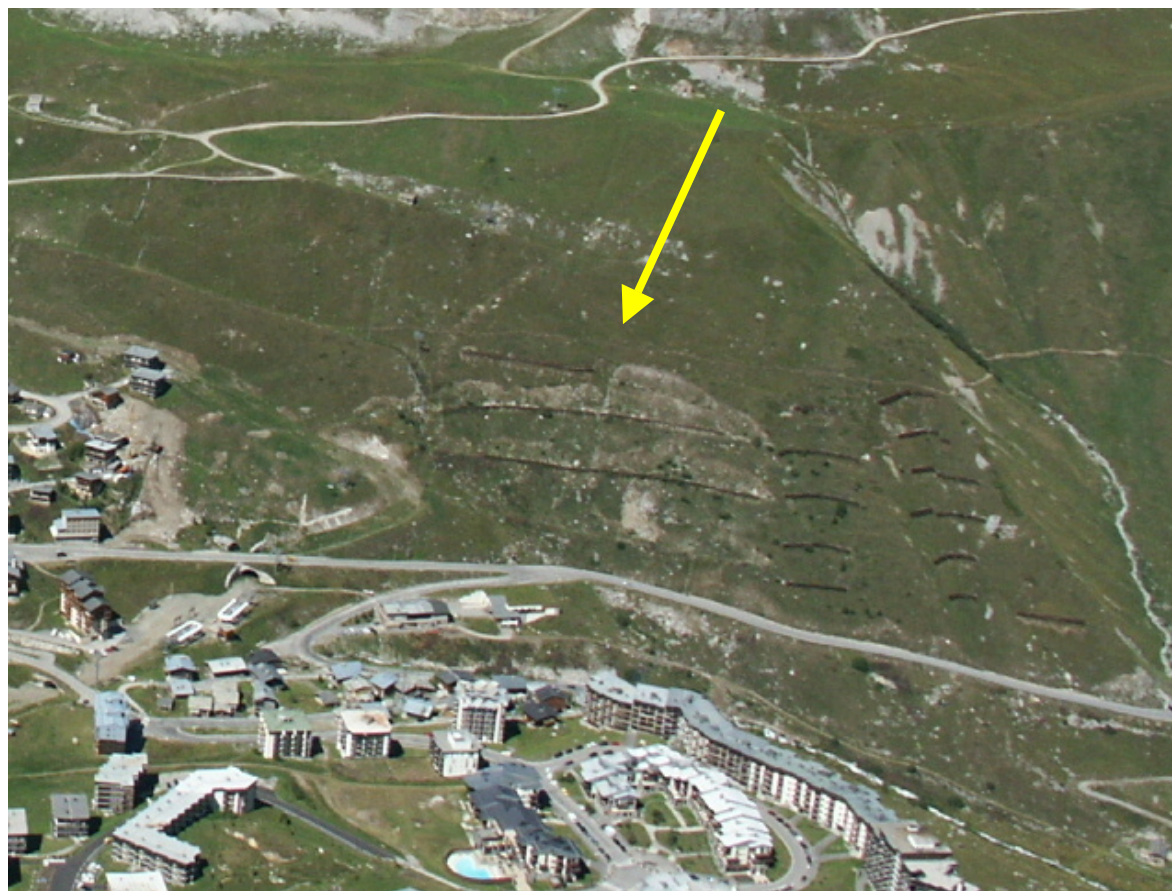
Ouvrage 22 : Les 3 lignes de râteliers et les banquettes larges couvrant la principale zone de départ des coulées au NE des Almes (cf fiche page 44)
