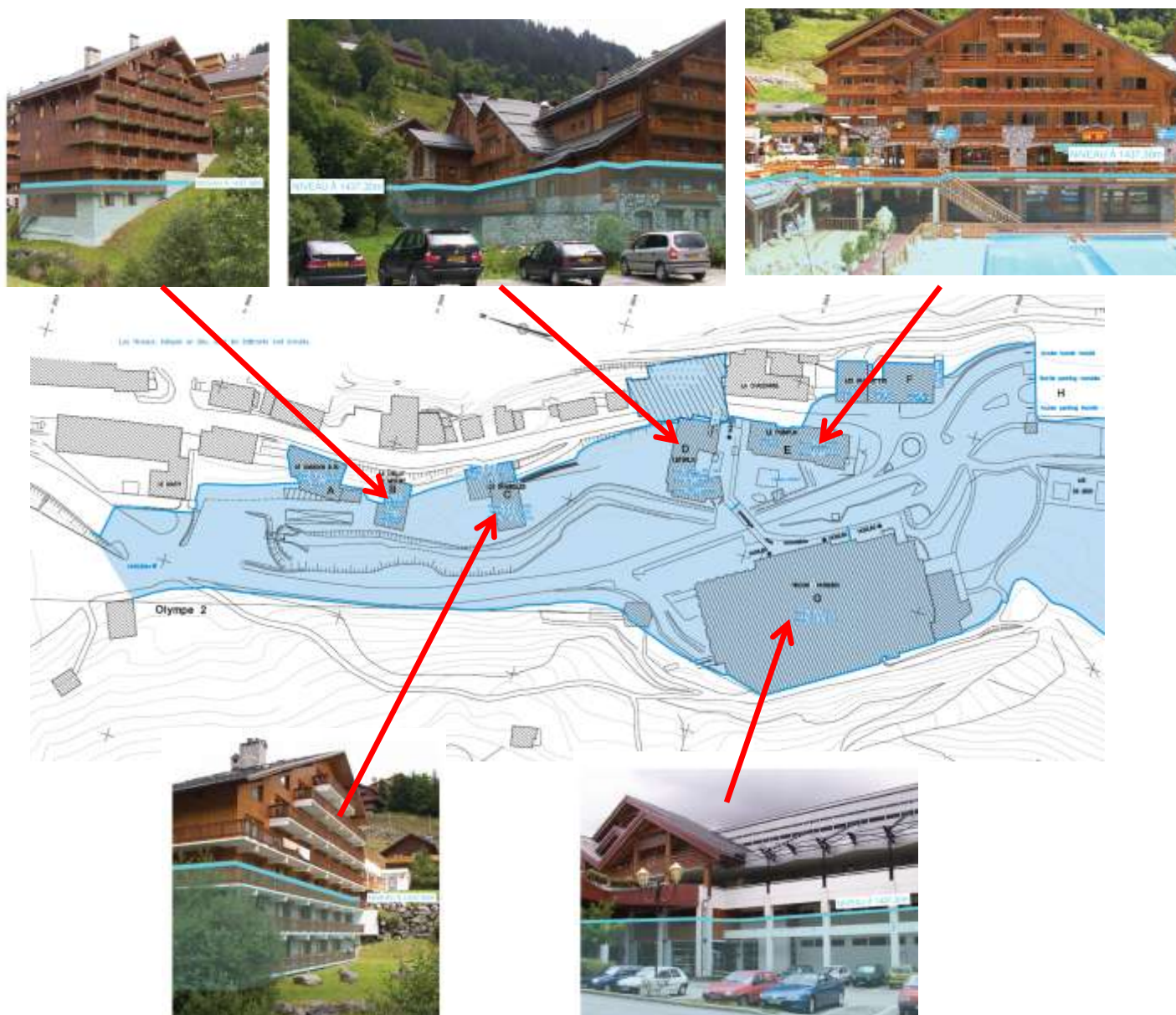
Figure 49 : Emprise de la crue centennale sur le secteur amont des Ravines et mise en évidence de la ligne d'eau à l'altitude 1437.30 mètres sur les habitations. (Hydrétudes)
