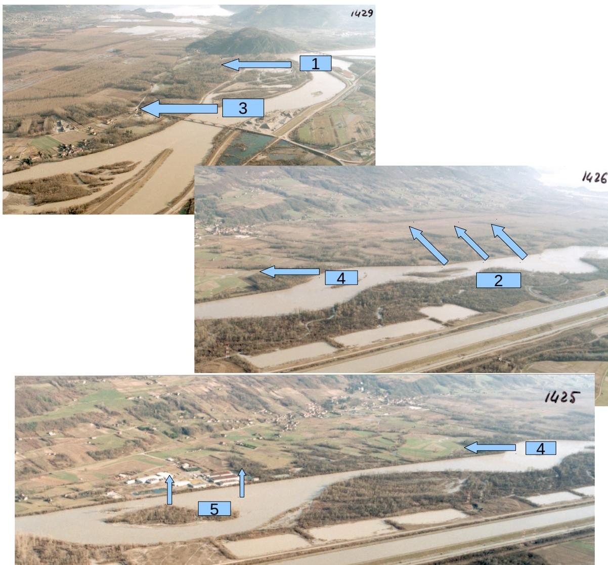
Le remplissage de la plaine de Chautagne dépend de la durée des débordements mais également du niveau du lac du Bourget et de ses capacités de stockage.
