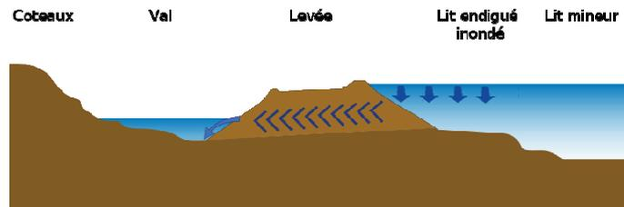
Il s'agit d'une défaillance possible de l'ouvrage. Les infiltrations d'eau éventuelles pourraient créer des voies d'eau dans le corps de digue entraînant la rupture de cette dernière. La localisation la plus probable de ce phénomène se situe au droit des pertuis de fond ou des canalisations à l'intérieur du corps de digue (zone préférentielle d'écoulement linéaire).
