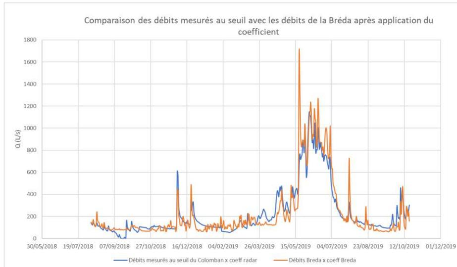
Comparaison des débits mesurés au seuil avec les débits du Bréda après application du coeff ajusté
