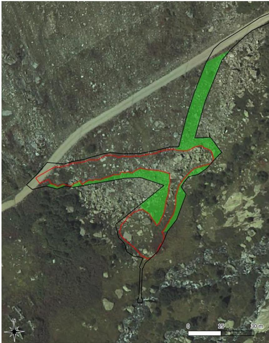
Surface maximale estimée des milieux « Champs de blocs » initialement présent pouvant être remise en l'état après les travaux, soit 1000 m<sup>2</sup>. En noir figure l'emprise du chantier et en rouge l'emprise de terrassement de la piste d'accès et de la centrale.
