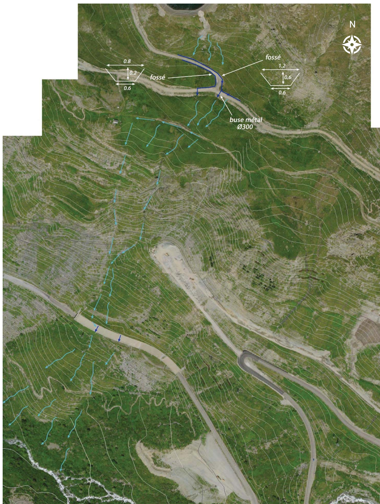
Cheminements potentiels des écoulements à l'aval du déversoir de la retenue Echauds 2
