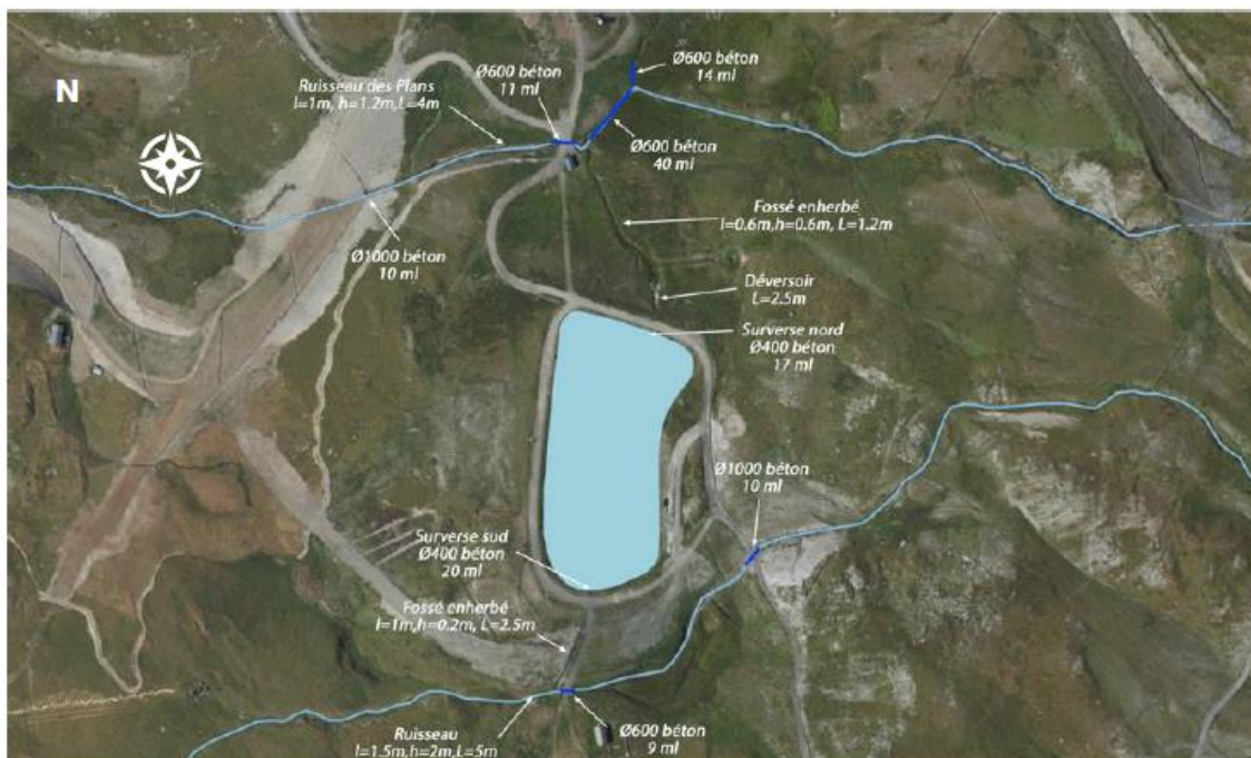
Schéma des exutoires des surverses du lac de Echauds I. Source : ABEST.
