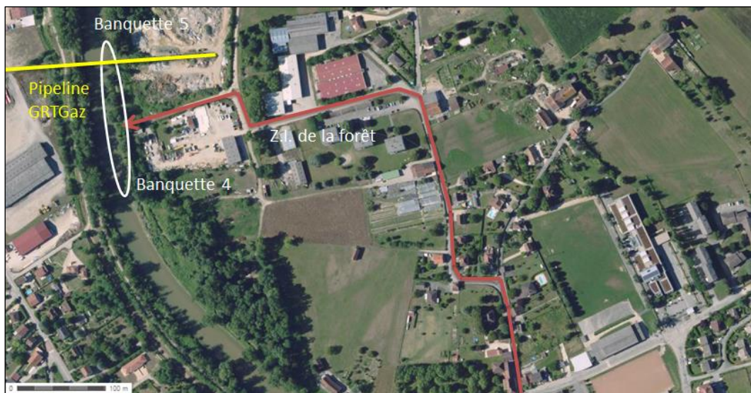
Figure 8 : Plan d'accès pour les travaux d'aménagements de la banquette 4
