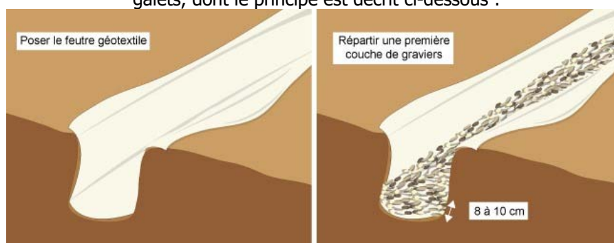
Figure 12 : Schéma de principe – tranchée drainante
