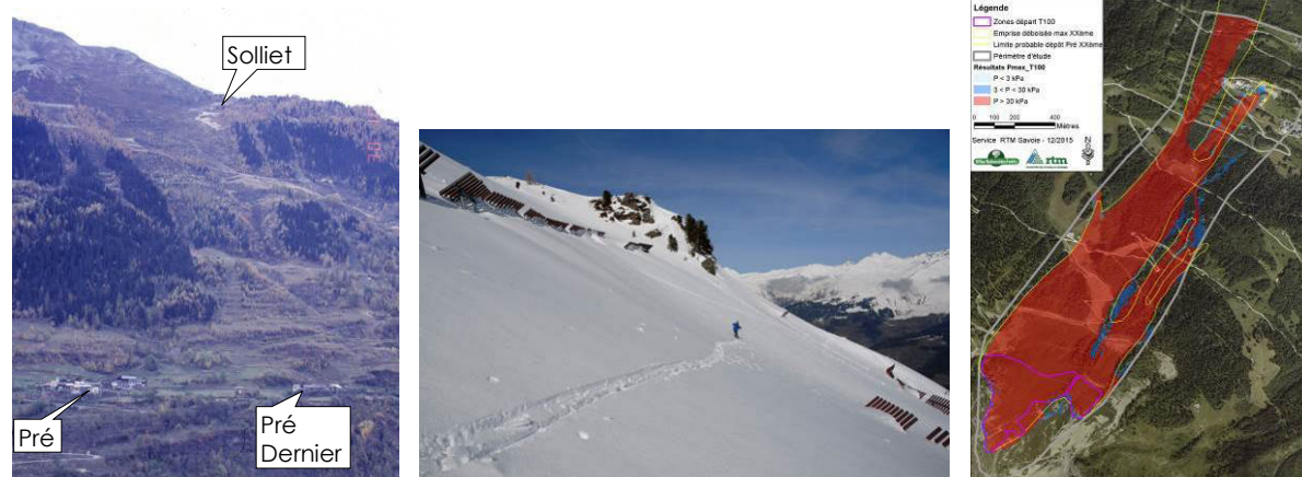
A gauche : versant en 1985 ; au centre : interligne de râteliers de 45 m ; à droite : simulation Ramms pour T=100 ans
