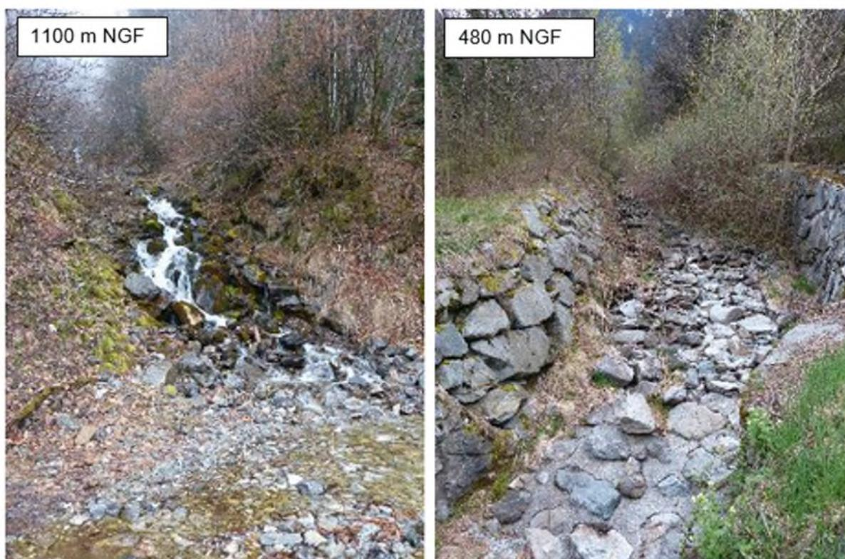
**Figure 49 – Goujon photographié avant la fonte le 10 avril 2018 : l'eau présente en amont est infiltrée dans la section aval (source : Hydrostadium)**
