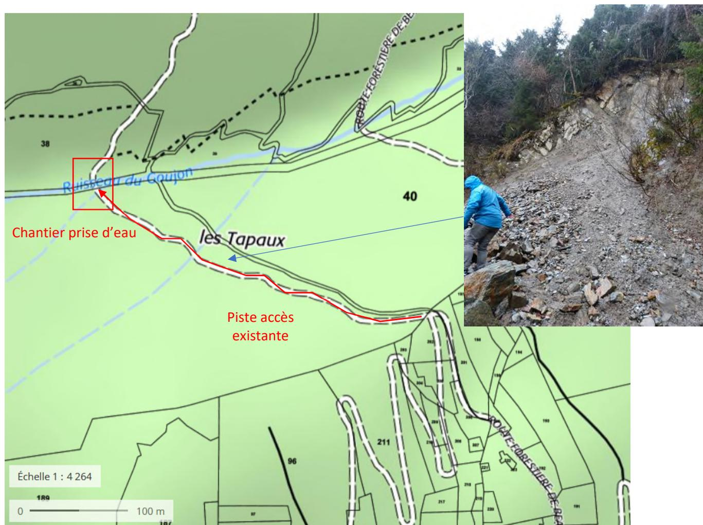
Figure 75 – Accès prise d'eau + photographie d'un glissement le long de la piste (2018)
