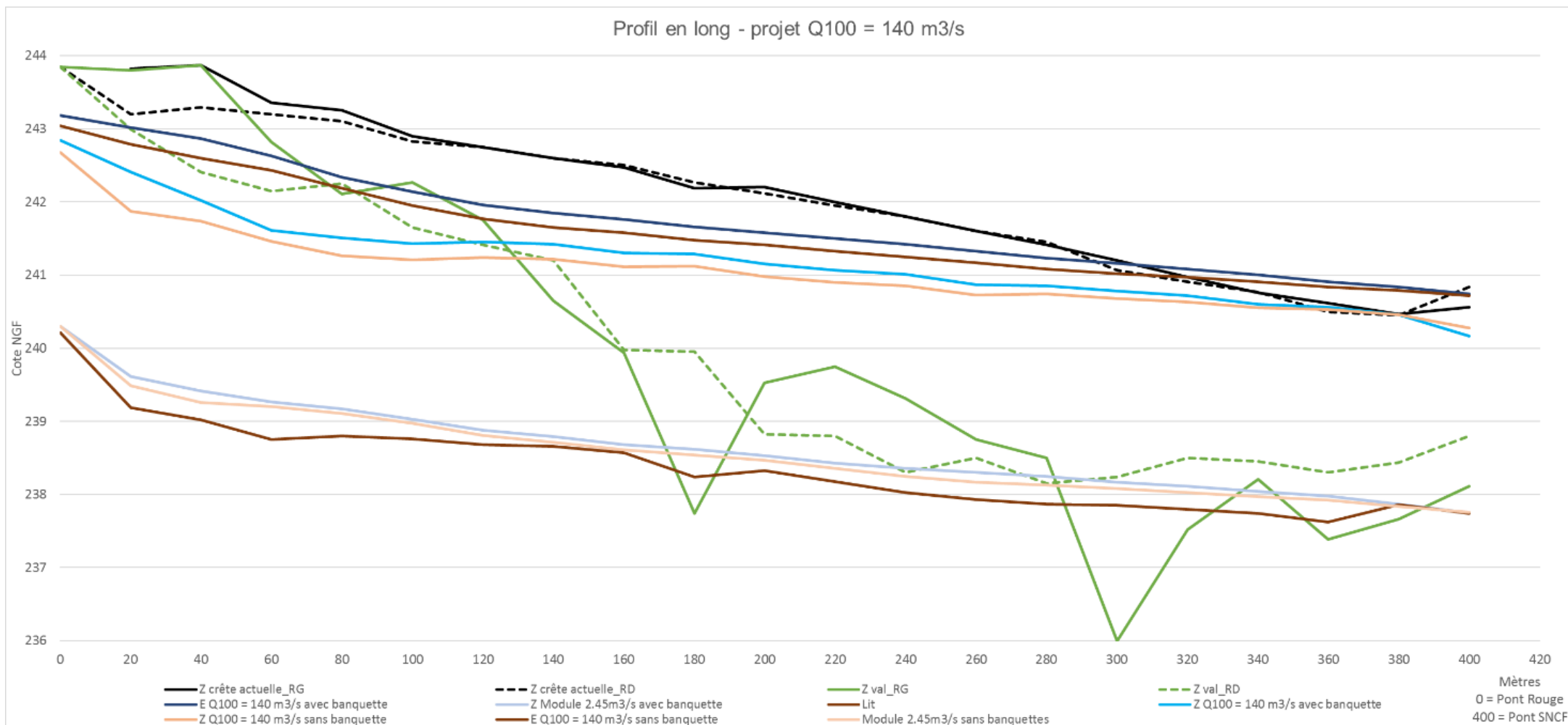
Figure 15 : Profil en long des digues existantes et des leurs vals
