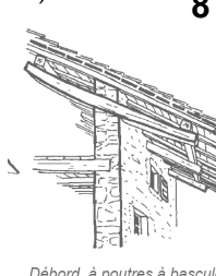
Débord à poutres à bascule
