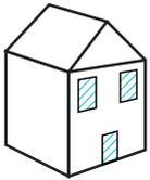
Ouvertures petites au rythme régulier ; Menuiseries en bois d'aspect naturel ; Des linteaux en bois peuvent être présents, formant un chaînage double aux fenêtres ou simple aux portes.
